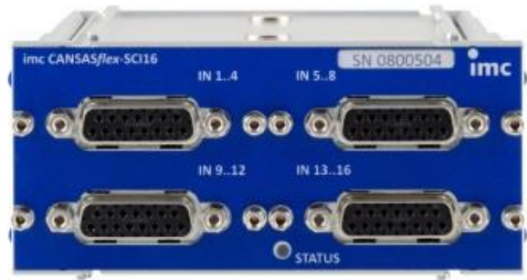
Abb. 4: Messmodul imc CANSASflex-SCI16
