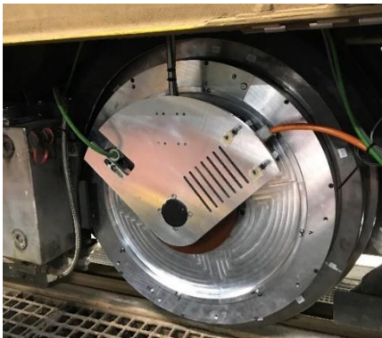
Abb. 2: Messrad an Straßenbahn montiert © GHH-Radsatz
