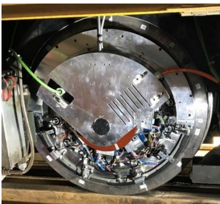
Abb. 3: Das MTP Telemetrie-System am Messrad © GHH-Radsatz
