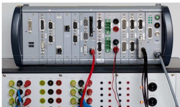
Abb. 3: imc CRONOScompact: universelles modulares Messsystem mit HiL-Erweiterung (eingebetteter Simulations-Prozessor)
