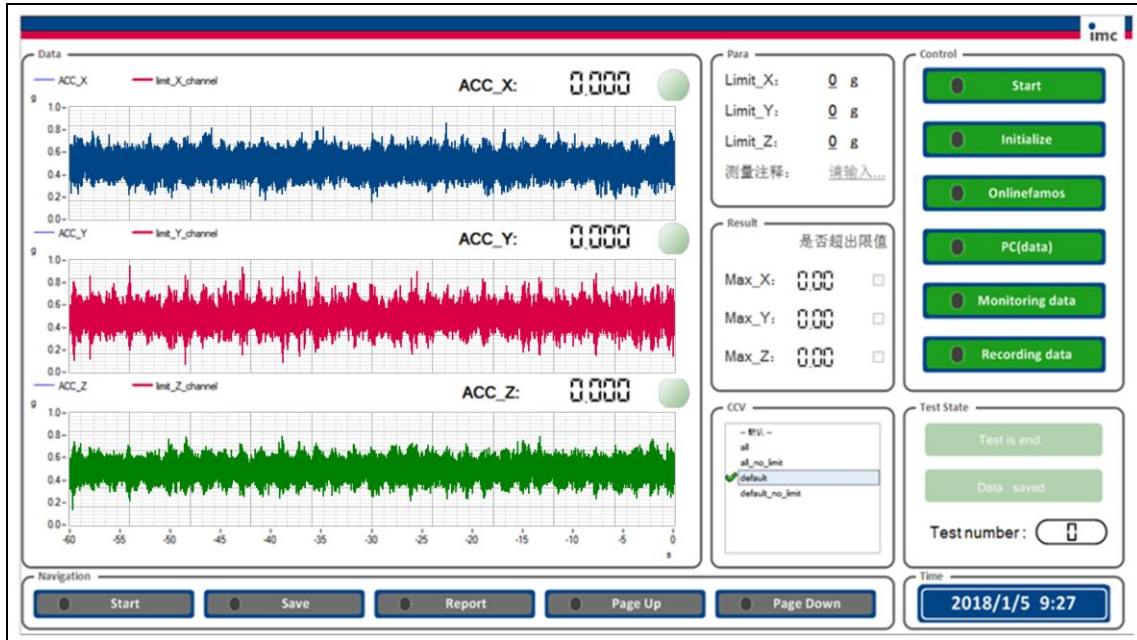
Abb. 8: GUI für automatisiertes Messen in imc STUDIO @imc
