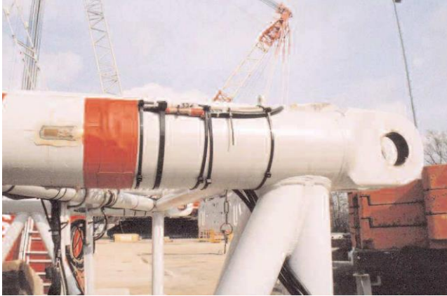
Abb. 2 Dehnungsmessstreifeninstallation an gittermastförmigem Teil eines Auslegers
