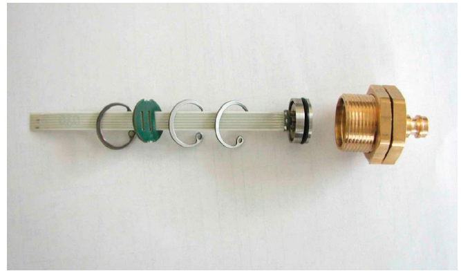
Bild 1: Drucksensor mit integriertem Sensor PROM mit Sensordaten und Einstellparametern für den Messverstärker
