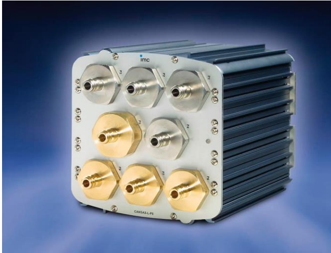
Bild 3: 8-kanaliges Druckmessmodul, imc P8, mit CAN-Bus Ausgang. Der im Messmodul integrierte Sensor beinhaltet ein Sensor PROM zur Speicherung des elektronischen Datenblattes.
