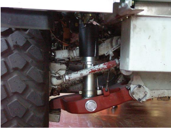
Abb. 3: Vollhydraulisches Fahrwerk (DTS) der Firma VSE
