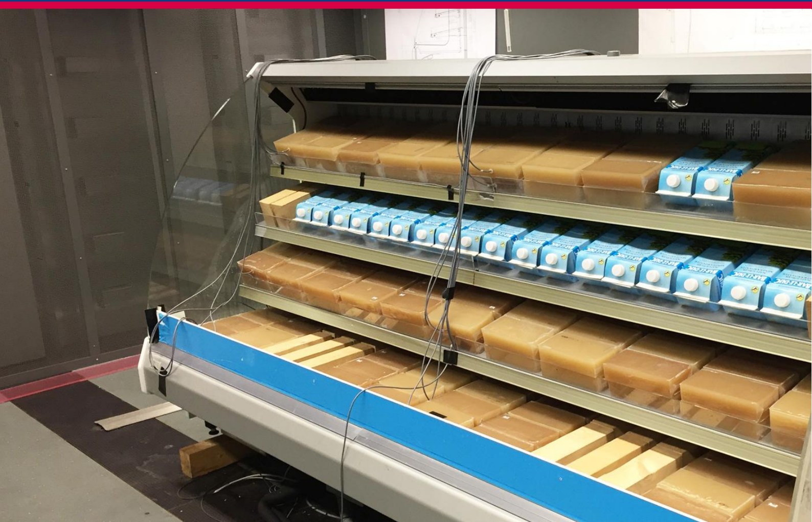
Bild 1: Smeva-Kühlregal mit simulierten Produkten zur Temperaturprüfung.
