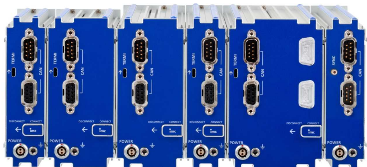
Rückseite des Blocks: CAN, Versorgung, Terminator, Verriegelungs-Schieber
