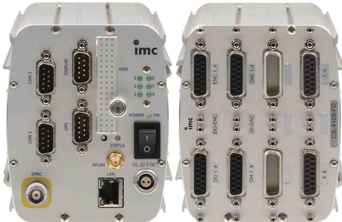
Gerätetyp: CS-4108-FD, 8 analoge Messeingänge
