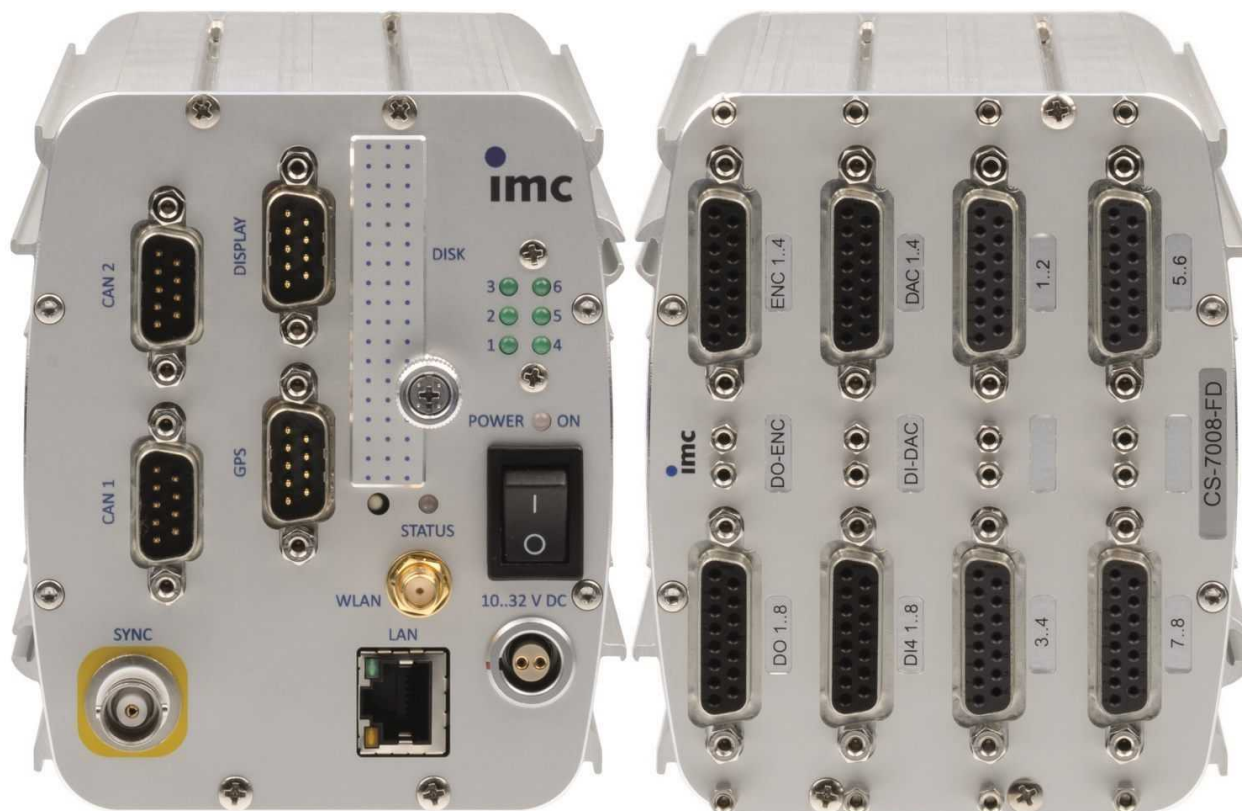
Gerätetyp: CS-7008-FD, 8 analoge Messeingänge
