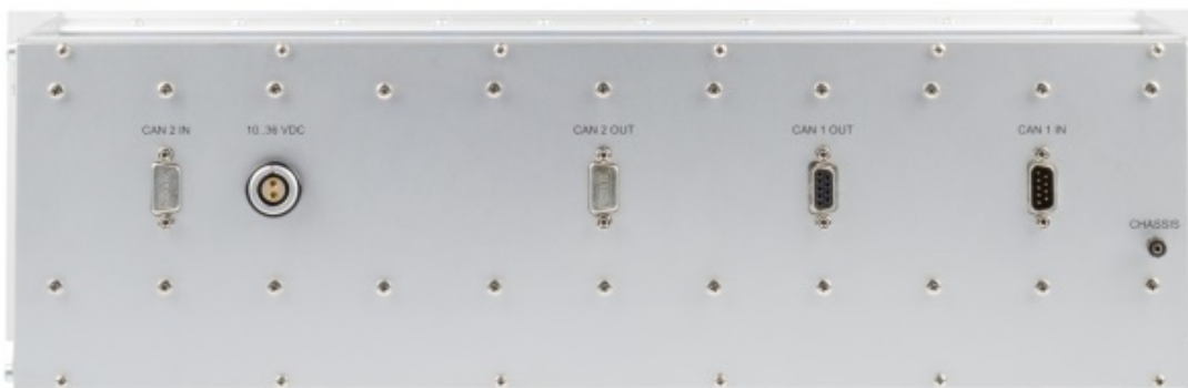
Anschluss CAN und Versorgung auf der Rückseite des 19" Baugruppenträgers (CAN/19BGT)
