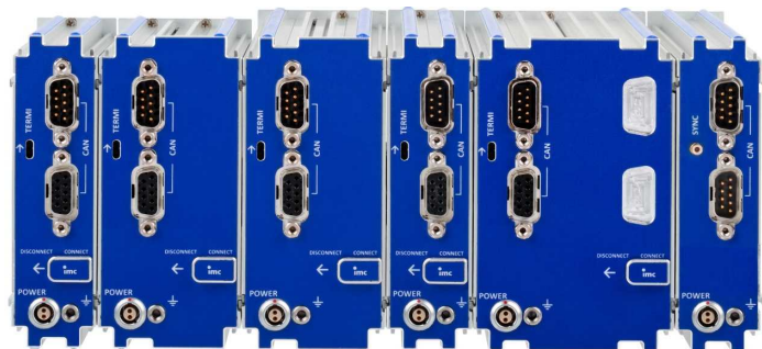
Rückseite des Blocks: CAN, Versorgung, Terminator, Verriegelungsschieber
