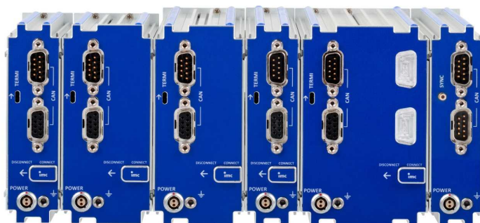
Rückseite des Blocks: CAN, Versorgung, Terminator, Verriegelungsschieber
