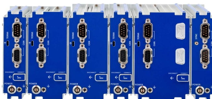
Rückseite des Blocks: CAN, Versorgung, Terminator, Verriegelungsschieber
