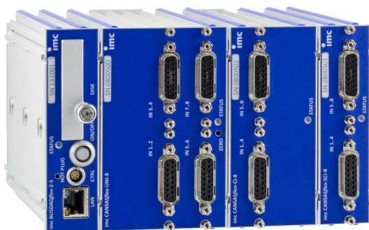
imc CANSASflex Module als Block (Klick-Verbindung) mit imc BUSDAQflex Logger (links)
