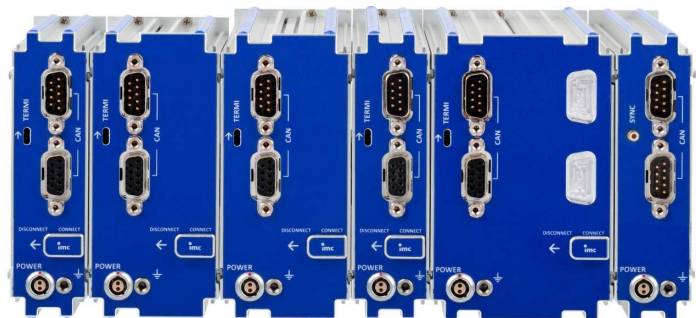
Rückseite des Blocks: CAN, Versorgung, Terminator, Verriegelungsschieber
