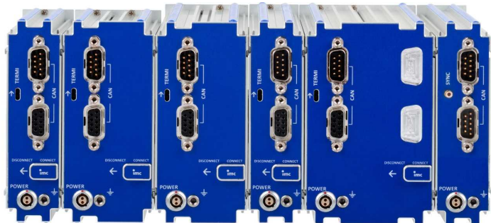
Rückseite des Blocks: CAN, Versorgung, Terminator, Verriegelungsschieber
