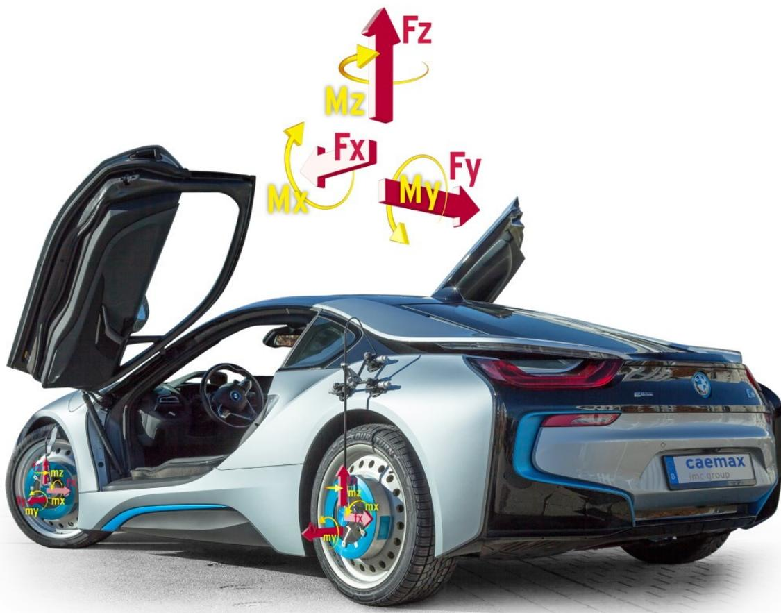
Abb. 22: i8 mit montierten WFT-C<sup>x</sup> an Vorder- und Hinterrad
