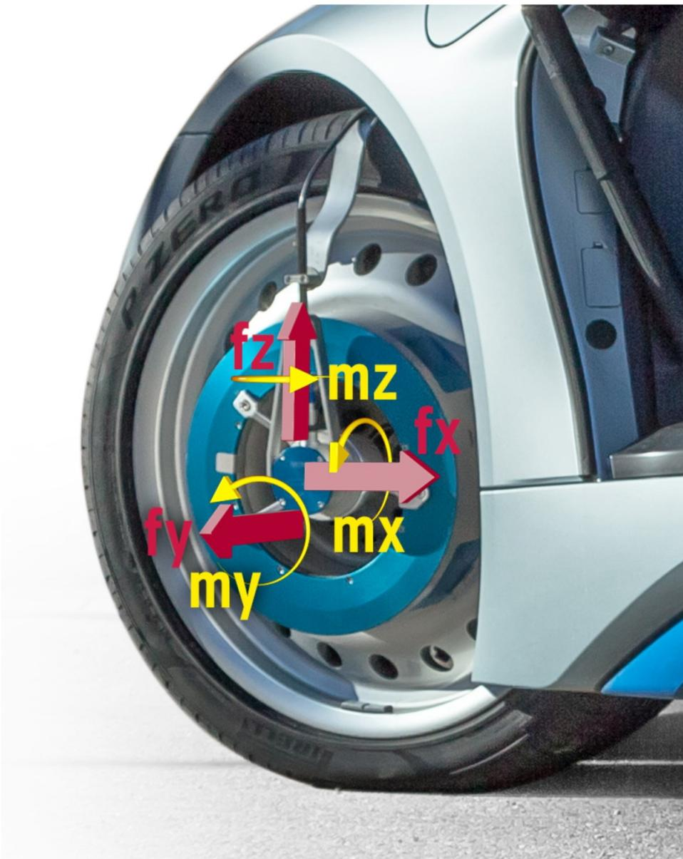
Abb. 21: Statoranbindung an das WFT, Vorderrad (Beispielfoto)
