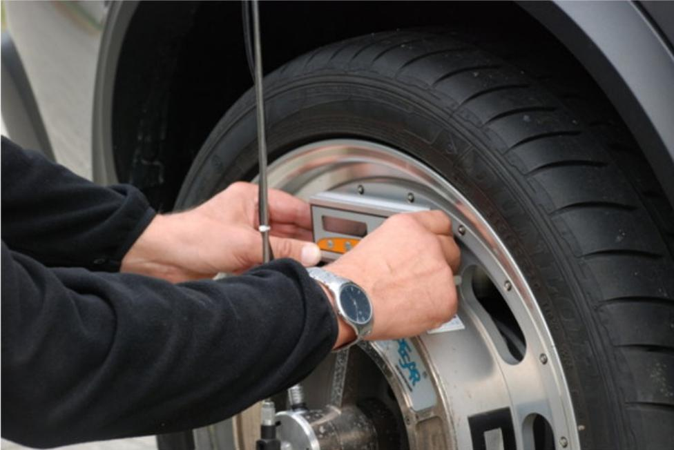
Abb. 28: Messen mit der Wasserwaage
