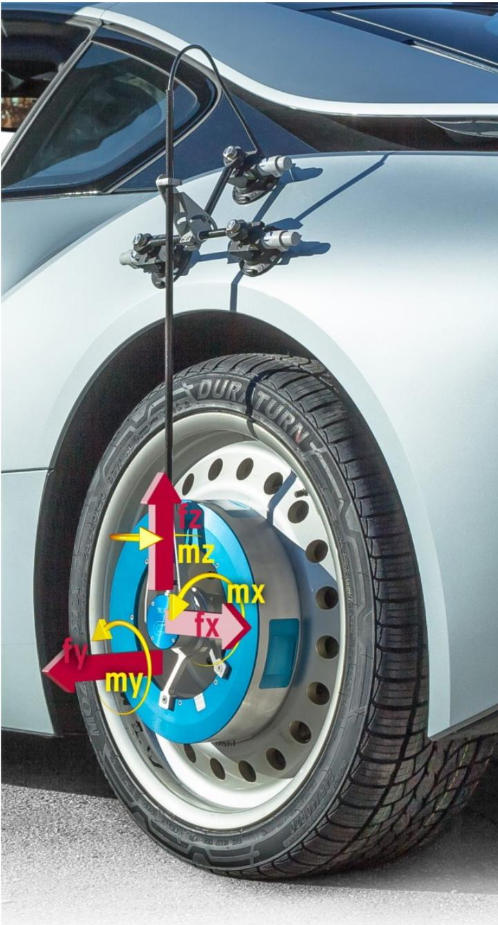
Abb. 20: Statoranbindung an das WFT, Hinterrad (Beispielfoto)
