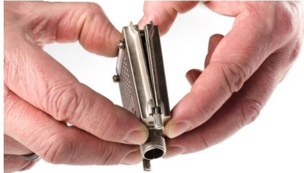
ACC/DSUBM-xxx: Deckel in einem kleinen Winkel ansetzen
