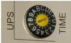
Um die USV Puffer Zeitkonstante einzustellen, sind beide mit einem HEX Schalter ausgestattet. Die Tabelle zeigt die einstellbaren Pufferzeiten.
