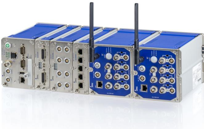
imc EOS Systeme können mittels des robusten imc Klick Mechanismus auf einfache Weise mechanisch fest verbunden werden, wobei eine gemeinsame Versorgungsspannung gleichzeitig elektrisch verkoppelt wird. Ein PTP-fähiger Netzwerk-Switch sowie eine gepufferte USV-Lösung und eine Sensorversorgung für Stromwandler werden ebenfalls in diesen zur imc CRONOSflex Familie kompatiblen Gehäusen angeboten.
