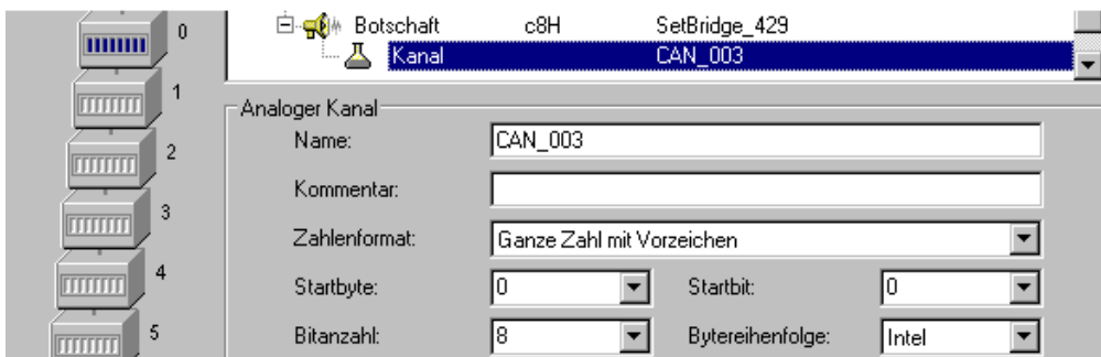
Kanal für den Abgleichbefehl
