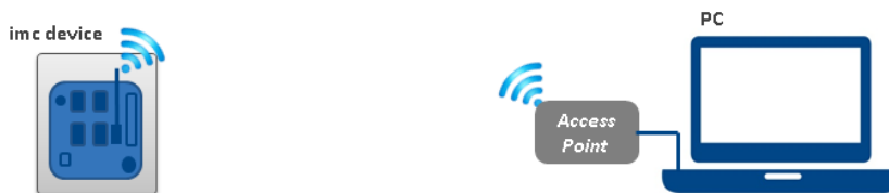
PC über Access Point - Gerät über integrierten WLAN
