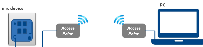
PC und Gerät über Access Points
