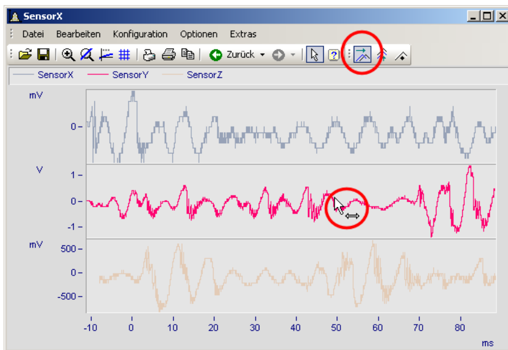
Line-Shift einer selektierten Linie in x-Richtung
