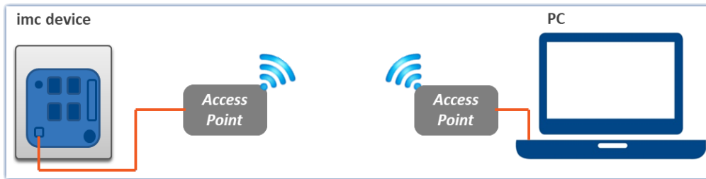
PC und Gerät über Access Points
