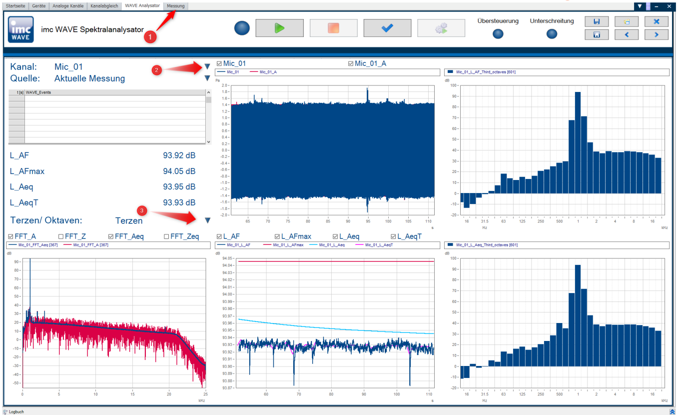
Seite "Messung" für Kanal "Mic_01" mit Terzen-Darstellung
