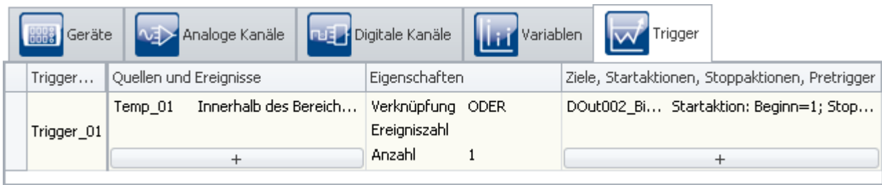
Triggereinstellung zum Setzen eines Bits
