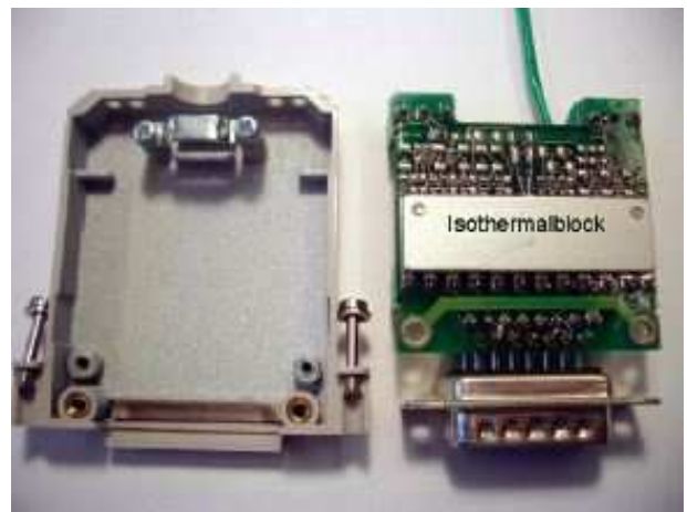
Rückseite der Anschlussplatine mit Isothermalblock
