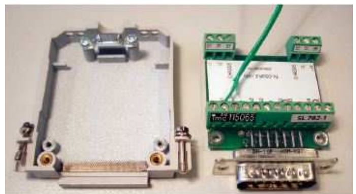
Geöffneter imc Anschlussstecker mit Thermoelement
